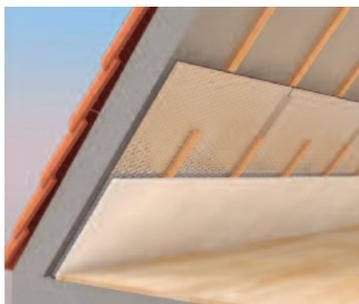
A solução passa pela aplicação de isolamento Space Reflex® e de placas de gesso.
