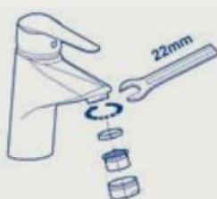
A instalação é rápida e fácil. Apenas precisa de substituir o filtro da misturadora por um novo, utilizando uma chave inglesa. A poupança será imediata.
