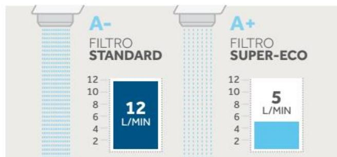
Com uma misturadora de lavatório standard, a média do consumo de água situa-se entre os 12 e os 16 litros/minuto, dependendo da pressão. Com o regulador de caudal situado no filtro das nossas misturadoras ECO, o caudal não ultrapassa os 5 litros/minuto, independentemente da pressão.
