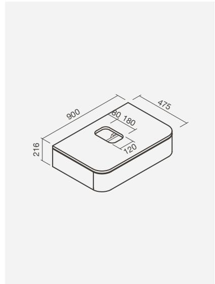
\* Profundidade do lavatório ligeiramente superior à do tampo / móvel
