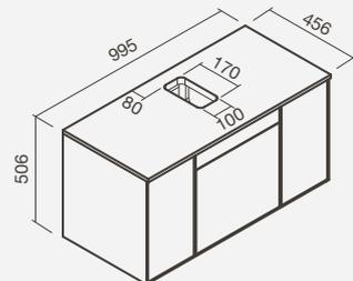
\* Profundidade do lavatório ligeiramente superior à do tampo / móvel
