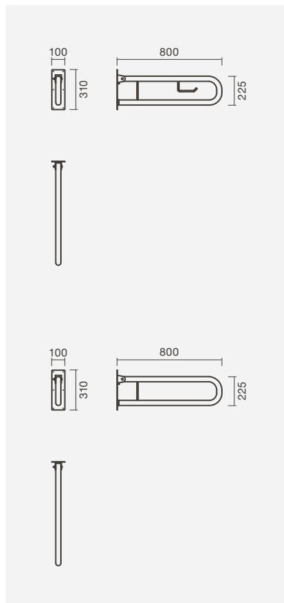
**Barra de apoio para sanita - fixa**
