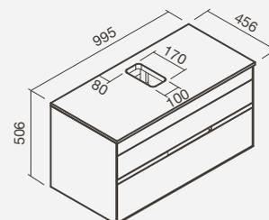
\* Profundidade do lavatório ligeiramente superior à do tampo / móvel
